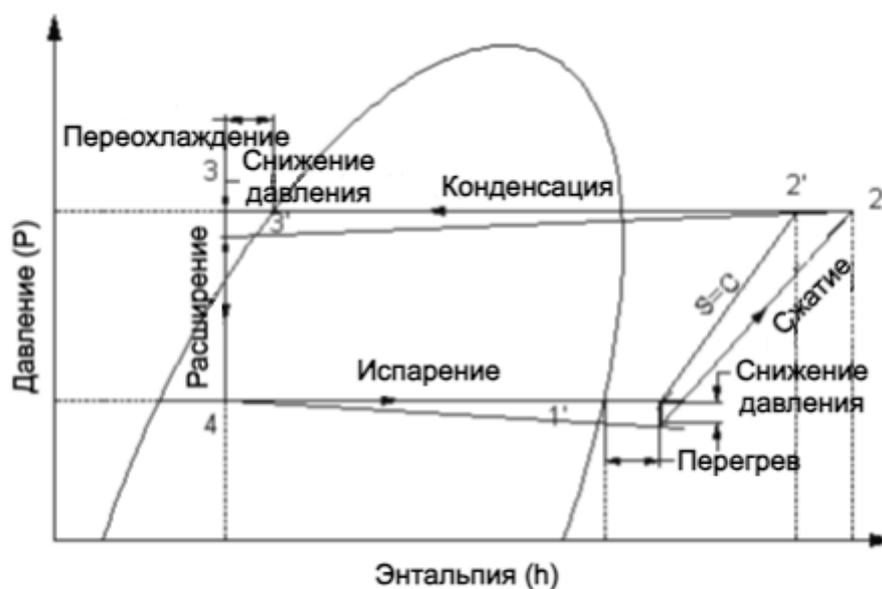
Рисунок 18 – Диаграмма давление-энтальпия в системе теплового насоса
