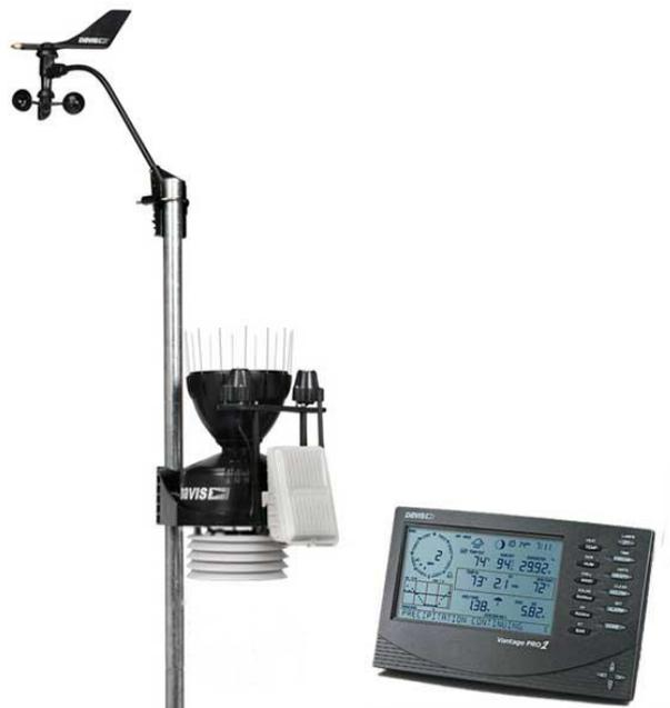
Рисунок 17. Метеостанция Davis Vantage Pro2 Plus Cabled с консолью
