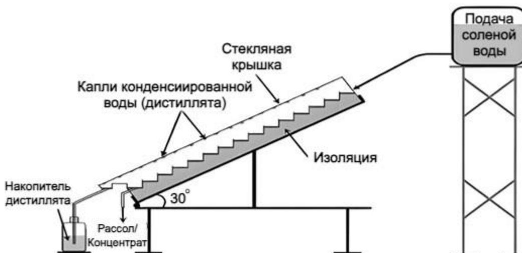
Рисунок 3 – Схематический обзор каскадного солнечного опреснителя [3]
